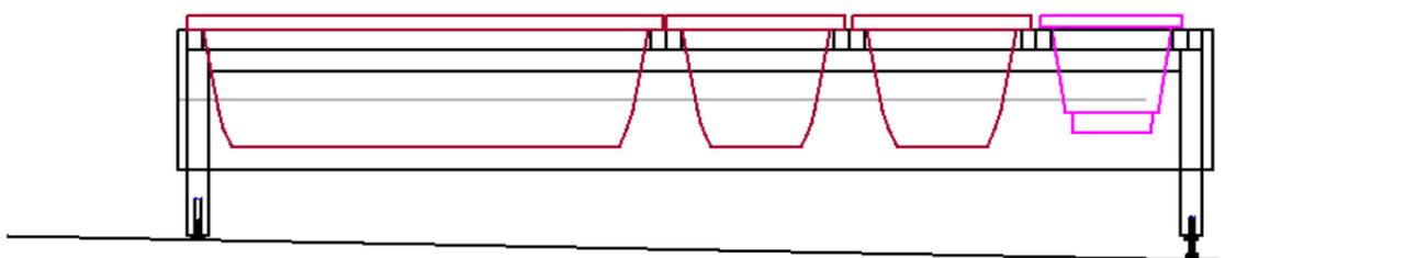
坂道や、荒れ地には柱の長さを現地調整できます。微調整はボルトで。
